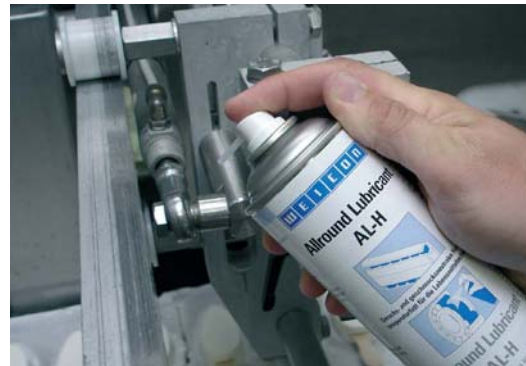
Lubrifierea unor rulmenți
